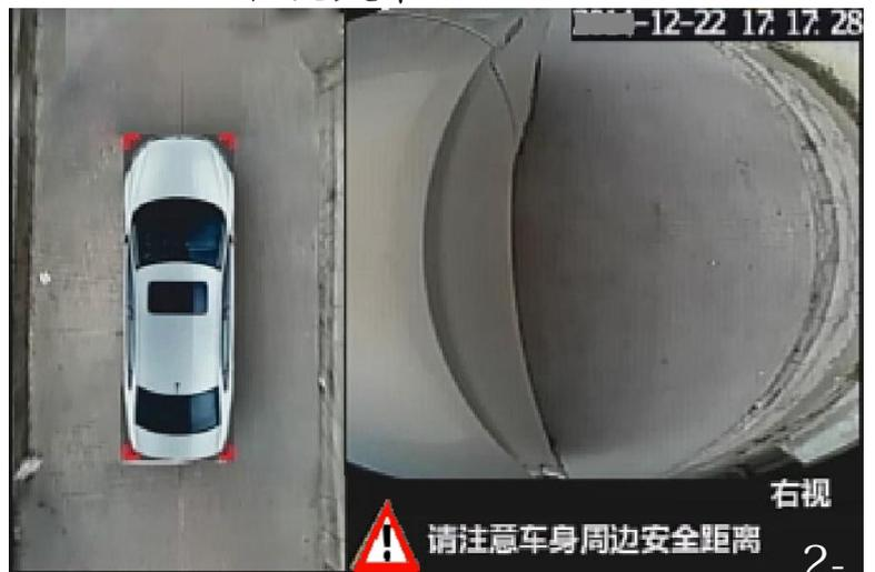
1.左右全景画面默认只显示前轮和车身的一部分如图（2-2、2-3），用户可根据自己的习惯。如果想让全景左右画面显示前轮和后轮，请进入单画面调整，使用压缩或平移来实现如图（2-5、2-6）。2.也可在转向控制中设置成全屏显示单个画面。备注：此画面设置不影响录像范围大小和效果。
